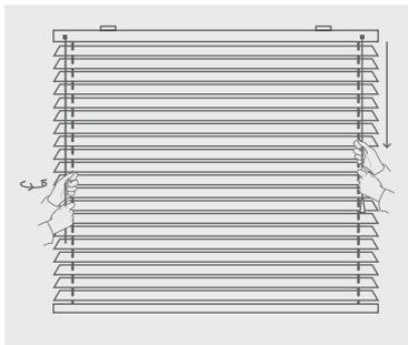
Mettre les lamelles du store en position horizontale avant de le baisser/lever et cela afin de prolonger sa durée de vie.
